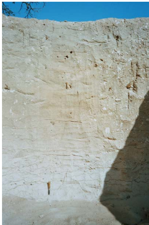
Photo – Profil des sols de la zone d'étude – Traces d'accumulation d'argile dans le bas du profil.
